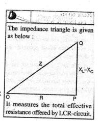
When  $E = E_0 \sin \omega t$ , then  $i = i_0 \sin (\omega t - \phi)$
